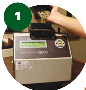
Colocando grãos dentro do determinador de umidade
