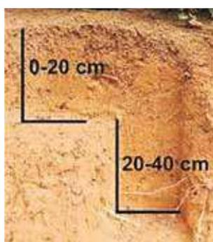
A coleta das amostras pode ser feita com um enxadão, trados, sondas e até mesmo com broca helicoidal acoplada a uma furadeira. É importante recolher a mesma quantidade de solo em cada subamostra.
