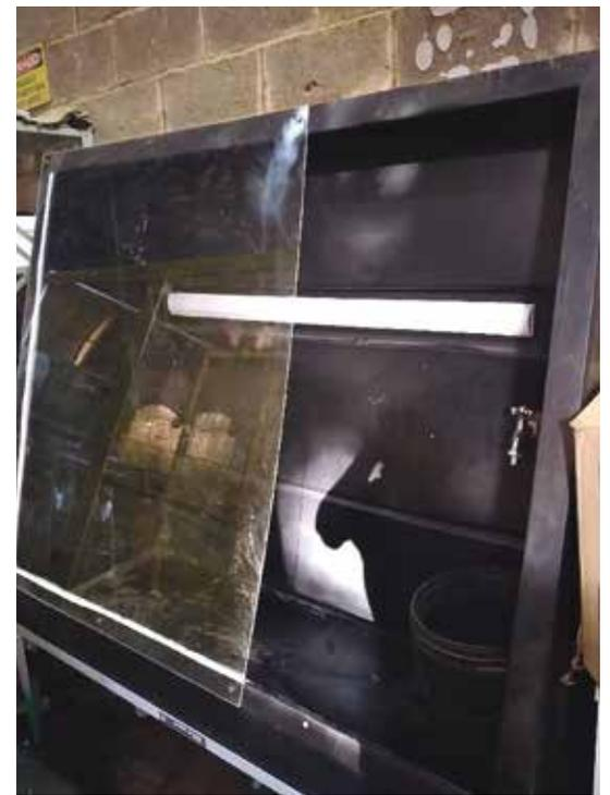
Novo equipamento utilizado para lavagem dos carimbos e reservatório com recirculação de água.
