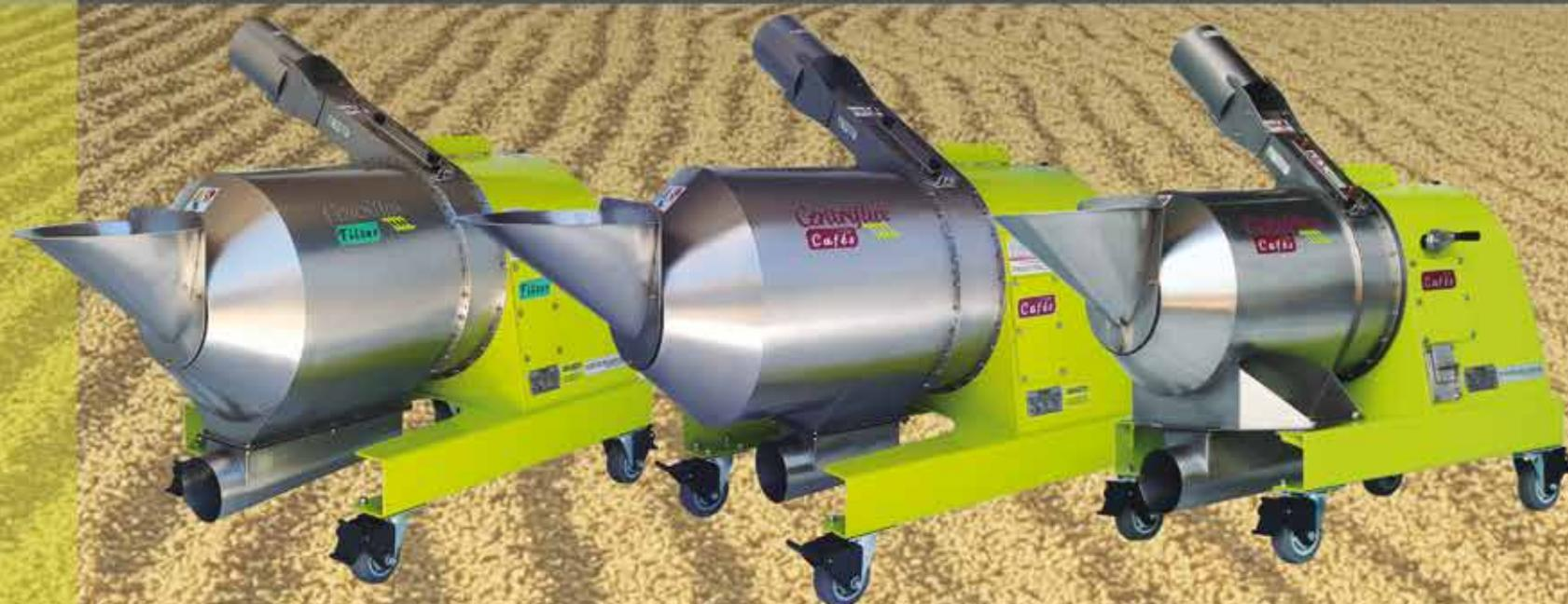
**Centrifuga e transporta todos os Cafés que são processados na via úmida**
