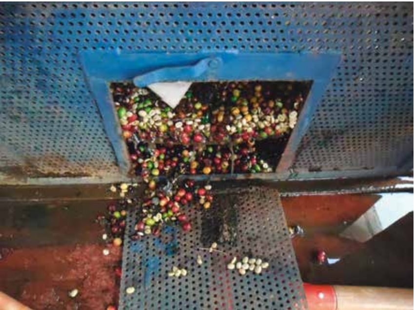
Pé de elevador antes da limpeza diária
