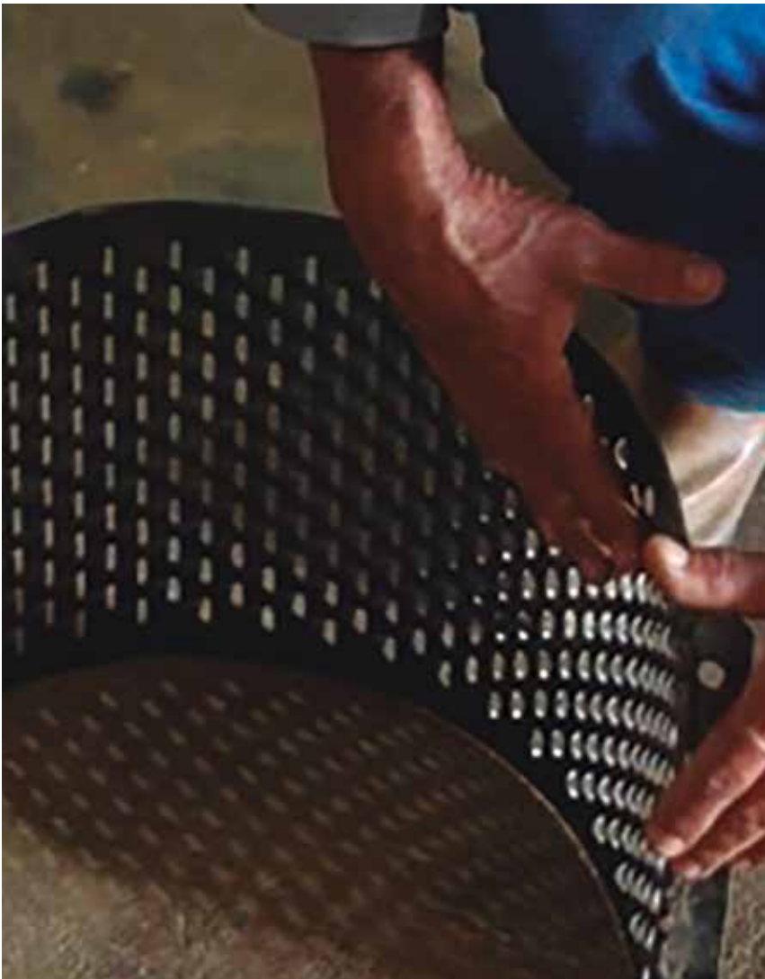
Substituição de vazadeira
